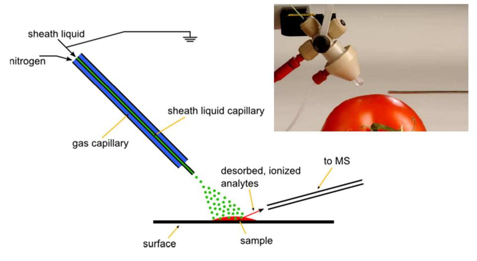
Schematische Darstellung der Desorptions-Elektrospray-Ionisations (DESI) Quelle
